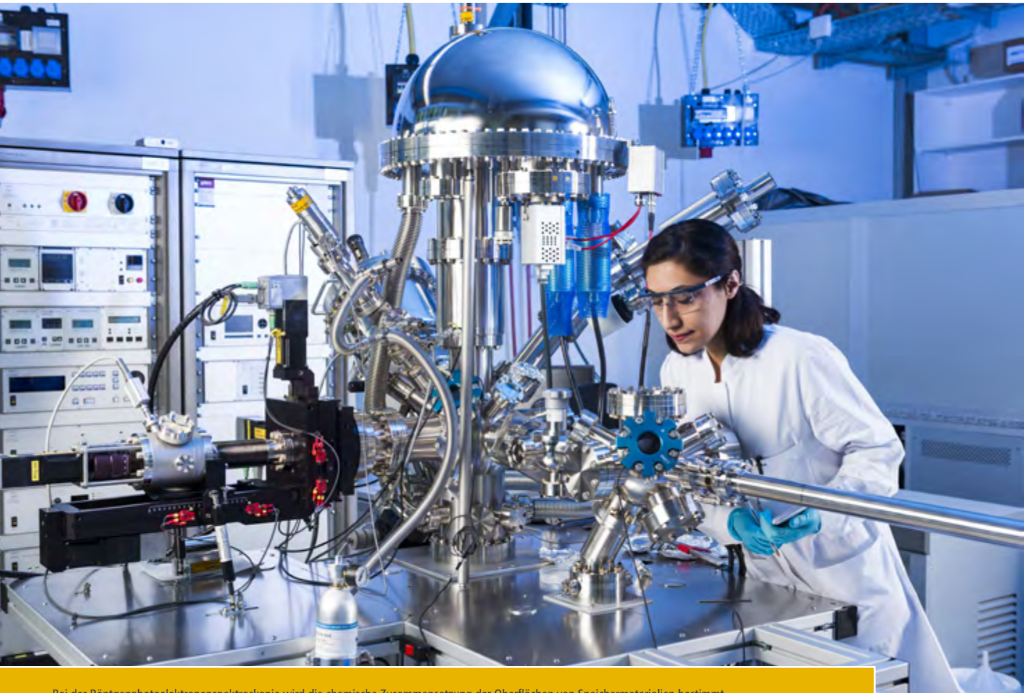
Bei der Röntgenphotoelektronenspektroskopie wird die chemische Zusammensetzung der Oberflächen von Speichermaterialien bestimmt.
