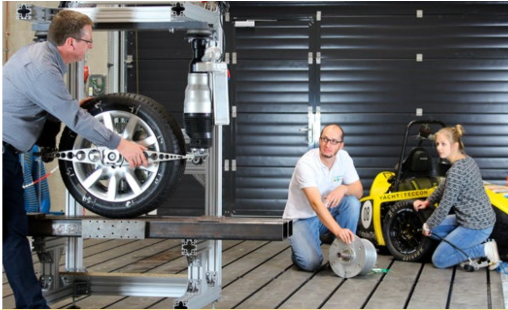
Durch eine geeignete Radaufhängung und geschickte Ansteuerung lässt sich eine Lenkkraftunterstützung für Elektroautos realisieren.
