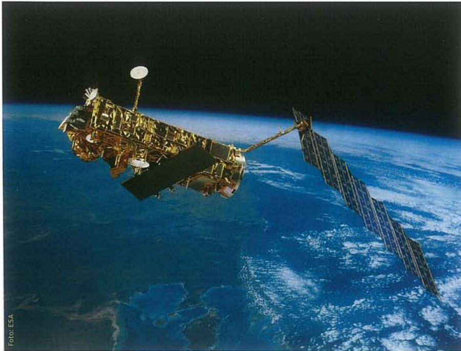
Ausflug in den Orbit: Umweltsatellit ENVISAT ausgestattet mit Spurengas-Messinstrument MIPAS des Instituts für Meteorologie und Klimaforschung.
