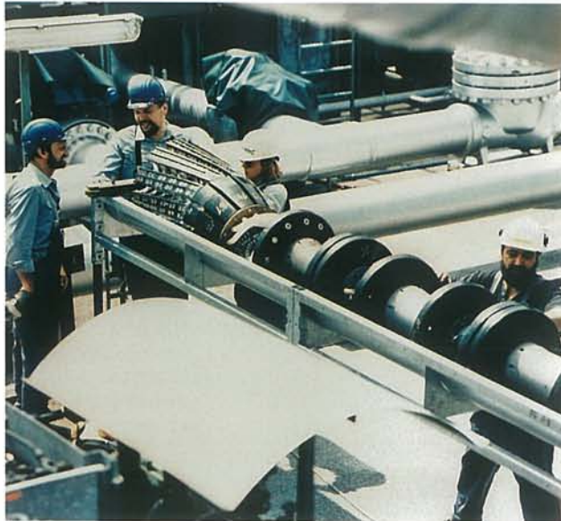
In Rissprüfmolchen zur Inspektion von Pipelines wird Messtechnik eingesetzt, die ursprünglich bei der Urananreicherung benötigt wurde.
