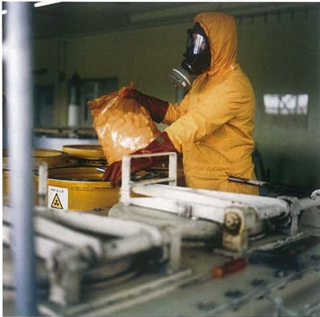
Originäre Karlsruher Entwicklung und wichtiges Instrument für Entsorgungsdienstleistungen: Die Veraschungsanlage für schwachaktive brennbare Abfälle.
